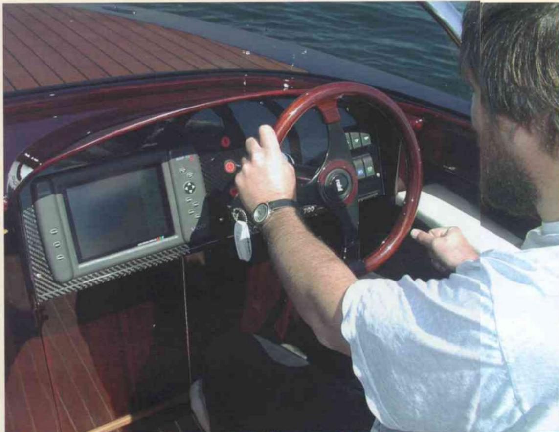
Links: Kontrast zum traditionellen Baumaterial Holz ist das Armaturenbrett aus Kohlefaser. Als Instrumentenpanel dient ein Plotter von VDO, der Navigations- und Motorendaten anzeigt. Unten: Buglicht, versenkbar. Unten links: großes Cockpit und viel Liegewiese. Unter den Polstern sitzt der Diesel, Tanks und Stauraum. Das Seitenschott beim Motor lässt sich herausnehmen, so dass man gut an die Maschine kommt. Der Motorraum packt übrigens auch eine Doppelmotorisierung.
