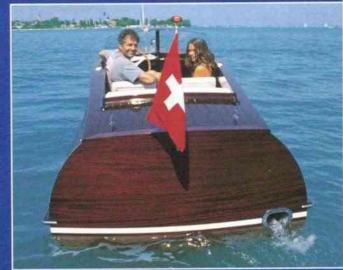
um die Wendigkeit und das Kurvenverhalten des mit einer starren Welle ausgerüsteten Bootes zu verbessern. Die Schale aus formverleimtem Sipo-Mahagoni (Vakuumverfahren) kommt ohne Spanten aus. Der Motor ruht auf zwei Längsträgern, der Boden ist 18 und die Seitenwände 12 Millimeter stark. Das Deck mit seinem Mahagoni-Stabdeck und die Seitenwände wurden gebeizt.
