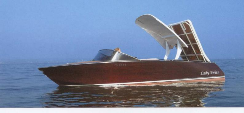
ankerung. Während des ganzen Vorganges, wenn das Dach aus- und eingefahren wird, sind keine Handgriffe nötig. Allein ein Knopfdruck steuert den ganzen Ablauf, der jede Funktion der Gelenke elektronisch absichert. Die elektronischen Überwachungen schliessen jeden Schaden aus. Die
